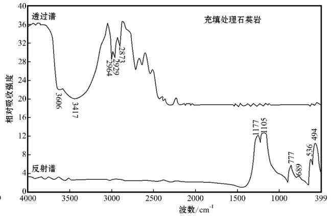
图 1 充填处理翡翠、石英岩的红外透过光谱和反射光谱
