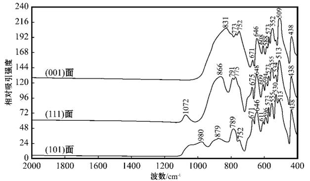
图 8 金绿宝石不同晶面的红外反射光谱
