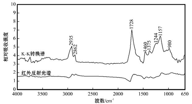
图5 琥珀的红外反射光谱及K-K转换谱
