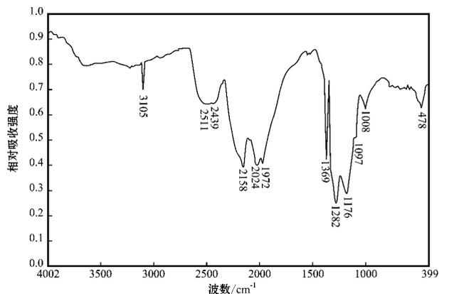
图 3 金刚石的红外透过光谱
