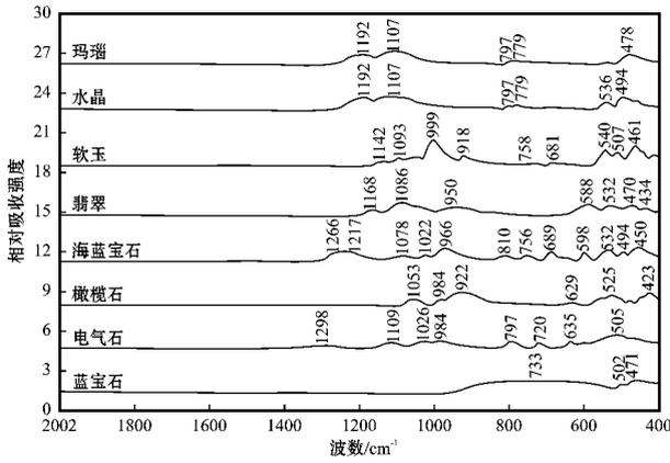
图 6 玛瑙、水晶、软玉、翡翠、海蓝宝石、橄榄石、电气石、蓝宝石的红外反射光谱
