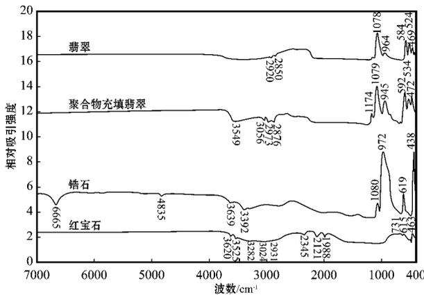
图 7 翡翠、聚合物充填翡翠、锆石、红宝石的红外反射光谱
