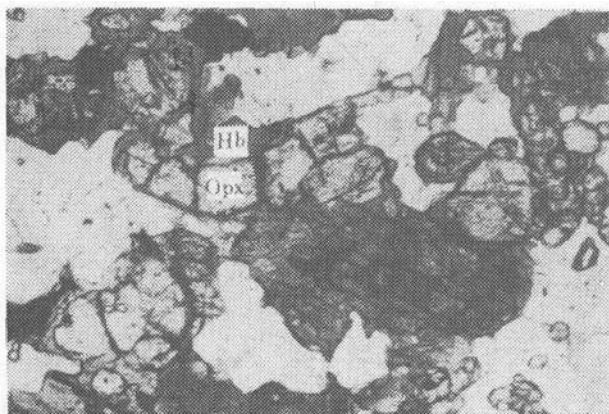
照片 1 普通角闪石 (Hb) 沿斜方辉石 (Opx) 的周边、解理缝分布, 形成反应边结构, 两者构成有规律的连生体。 单偏光 60× (铁铜沟)
